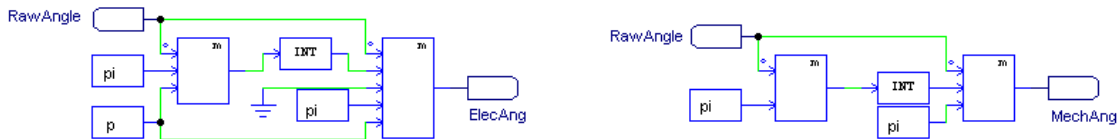
איור 15.10 – מעגלי עזר המחשבים את הזווית המכאנית (מימין) ואת הזווית החשמלית (משמאל) של הרוטור
