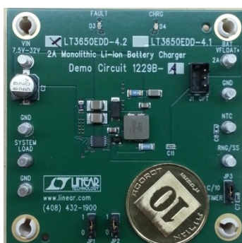
איור 9.5 – כרטיס פיתוח של מטען לסוללת Li-ion של חברת Linear
